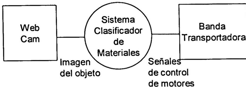
Fig. 1. Diagrama de contexto del SCM. Utilizará una WebCam para tomar la imagen del objeto, la cual se procesará y analizará en la PC, posteriormente la banda transportadora y las implementaciones necesarias realizarán la clasificación.
